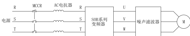
图3-14 主回路电机侧连接图
