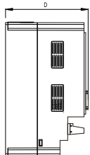
图2-4 单相0.4-0.75KW标准的外形尺寸
